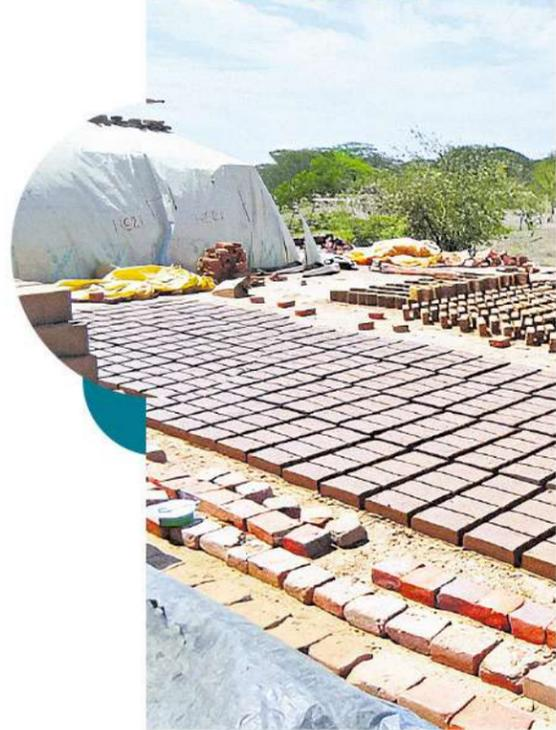
Las viviendas de la vereda Las Casitas cuentan con ladrillos más resistentes gracias a una técnica que permite aumentar la temperatura en el proceso de su cocción para hacerlos más fuertes.
