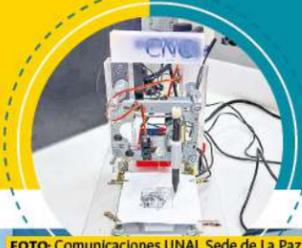
Prototipo elaborado con material reciclado que sirve para realizar ilustraciones mediante el uso de un software. Sus usos incluyen procesos de grabado y tallado en madera, acrílico o plástico, además de corte de papel y cartón para tarjetas, invitaciones y proyectos de manualidades.
