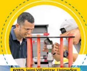
Prototipo de bajo costo para probar la resistencia de concreto y plásticos empleados en la elaboración de estructuras robóticas e impresión 3D.
