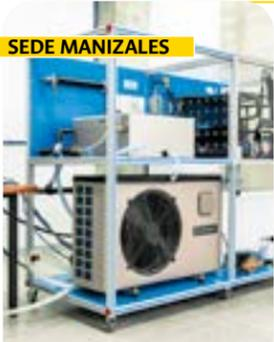
Con la adquisición de un equipo piloto único en el país la Sede lidera la investigación en energía geotérmica en Colombia, pues este permite analizar el aprovechamiento de energías renovables obtenidas del subsuelo para generar electricidad.
