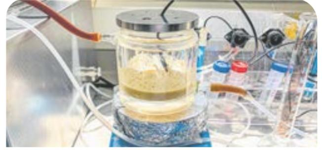
Ingenieros de la Sede Manizales diseñaron un prototipo que simula el proceso de "digestibilidad gástrica" del estómago. La herramienta, elaborada con vidrio de alto calibre que resiste alta presión y temperatura, sería muy útil para estudiar la calidad de los nutrientes. **FOTO:** archivo Unimedios.
